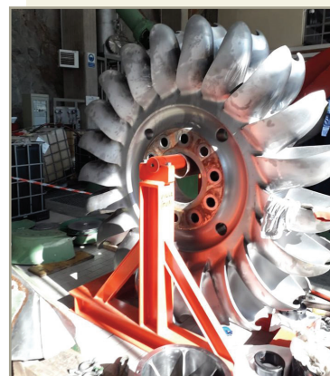
Fig. 19 – Turbină hidraulică verticală
